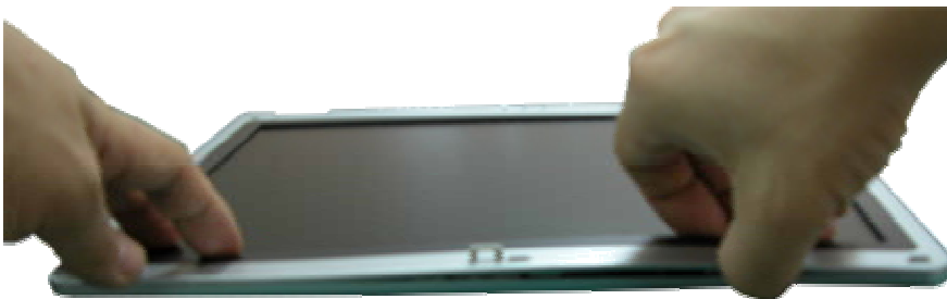
Fig. 26 Removing the LCD Bezel
